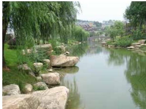
生态透水型的硬质驳岸，既能稳固驳岸，又能保持水生态，形成良好的滨水景观
