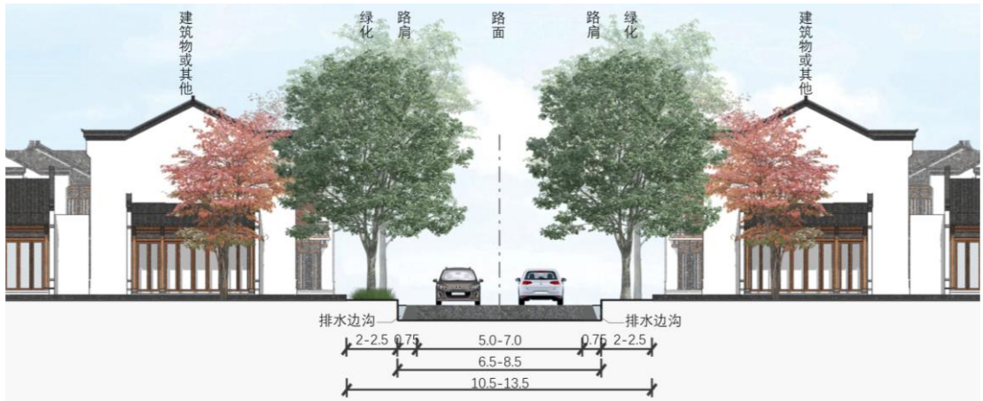
村庄主要道路路面宽度 5-7m
